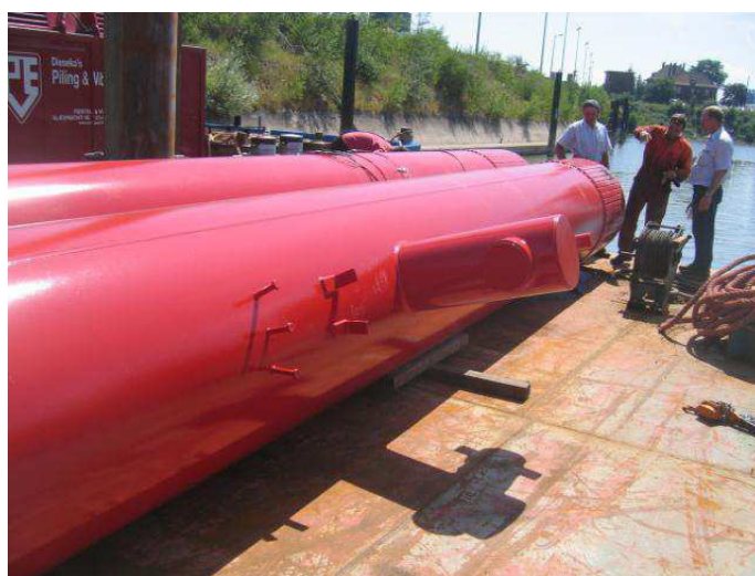
Bild 3 : Probefahl mit Pollern, Knaggen und Dübeln
